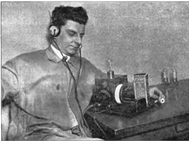
De foto toont een Amerikaansch Ontvangtoestel, dat werkt met een lamp, die slechts één droge cel noodig heeft voor Gloeistroom, waardoor de dure en zware accumulator overbodig is.
